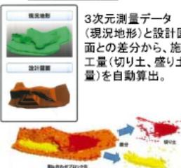
3次元測量データ(現況地形)と設計図面との差分から、施工量(切り土、盛り土量)を自動算出。
