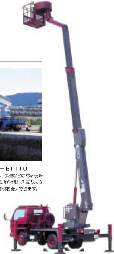
スカイマスター SJ-12A 長さ1.3m、0度から50度まで屈折する先端屈折アームにより、建物上面へのアプローチと壁面付近での上下移動、2つの作業領域が加わりました。
