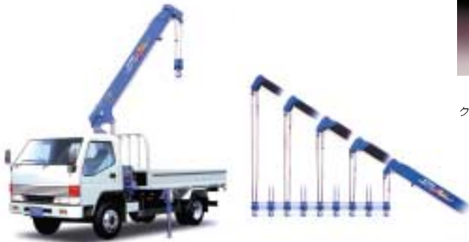
クレーン付トラック 新機能により、ブーム長さや起伏角度、ウインチ回転を変動させても、フックが自動的に上下して地面との並行移動など、安定した作業が行えます。
