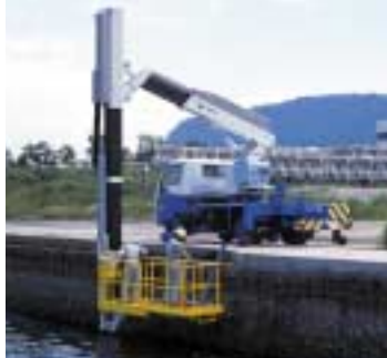
ブリッジチェッカー BT-110 最大作業半径が5.6mに拡大し、歩道などのある現場での作業も可能に。また、段差地や傾斜角度の入きい場所でも常に安定した作業姿勢を確保できます。
