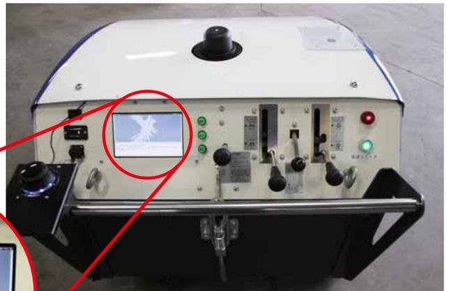
操作パネルでセンサーマーカの設置状態などを確認しながら自動運転の設定を行います。
