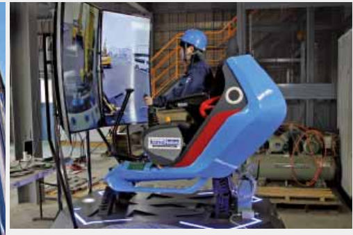
建設機械の運転席に設置した双腕双脚の人型ロボットを、コックピット型コントローラで遠隔操縦する「Kana Robo」 “Kana Robo” uses cockpit controllers to remotely operate a two-arm, two-leg humanoid robot placed in the driver’s seat of construction equipment
